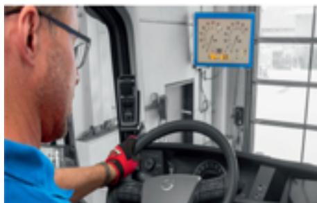
Roland Bertschi AG propose dans sa gamme de produits une nouvelle génération de testeurs de freins pour les camions et les machines agricoles. Avec des jeux de rouleaux de différentes tailles et conceptions et plusieurs modèles pour la simulation de poids avec une faible tension ou un dispositif de levage. Pour les essais de freinage selon la norme ISO 21069. Variantes d'affichage selon les besoins du client. Installation également dans des fosses existantes.
