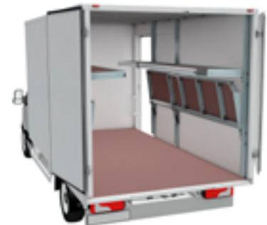
ECKOLD-Klapp, le système d'arrimage et de rayonnages repliable a été conçu pour une utilisation optimale, quels que soient le type et la taille des marchandises à transporter. Grâce à la construction modulaire, le système peut être configuré à volonté.
