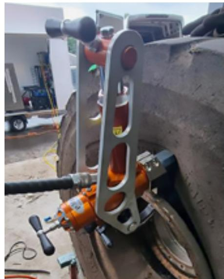
Même sur les jantes qui n'ont plus d'évidement dans la zone du talon, ce détalonneur peut être facilement fixé. Il permet de traiter toutes les jantes en plusieurs parties de 25" – 57" pour la zone EM. Cet appareil en aluminium de haute qualité est environ 40% plus léger que les appareils comparables classiques, mais grâce à sa construction robuste, il reste très solide.
