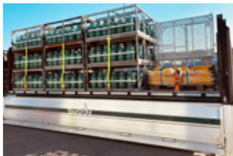
Trois points d'intérêt d'un seul coup: Sécurité, ergonomie pour le chauffeur et économie. Un élévateur DH-VOZ.10.K9 d'une capacité de levage de 1000 kg a été installé de chaque côté avec une longueur de plate-forme de
